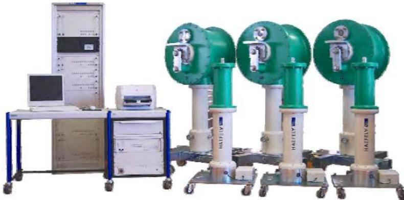
Измерение потерь в трансформаторах – это необходимый процесс контроля качества. Так как обычно пользователь трансформатора накладывает штрафные санкции за потери, возникающие в режимах нагрузки и холостого хода, наивысшая точность измерения потерь имеет важнейшее экономическое значение. Система TMS 580 разработана специально для высокоточных измерений потерь мощности в трансформаторах.
