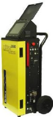
Мобильный анализатор изоляции **MIDAS 2880** выполняет автоматические измерения емкости, коэффициента потерь ( $\tan \delta$ ) и коэффициента мощности ( $\cos \varphi$ ) высоковольтной изоляции. Имеется встроенный мощный источник напряжения 15 кВ.
