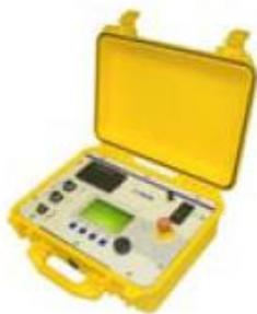
Прибор **TTR 2795** измеряет коэффициент трансформации, ток возбуждения и фазовый сдвиг между напряжениями первичной и вторичной обмоток.
