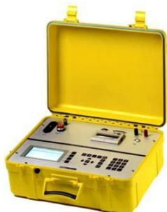
Измеритель восстанавливающегося напряжения **RVM 5462** записывает восстанавливающееся напряжение и анализирует состояние изоляции, отображая ее спектр поляризации.
