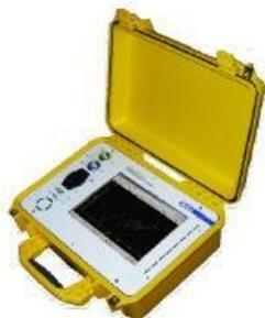
Анализатор частотных характеристик **FRA 5310**, сканирующий по диапазону частот, записывает частотную характеристику трансформаторных обмоток «отпечатки пальцев».
