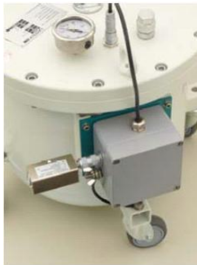
Присоединение блока резисторов типа 3723 к образцовому конденсатору типа 3370 NK/30
