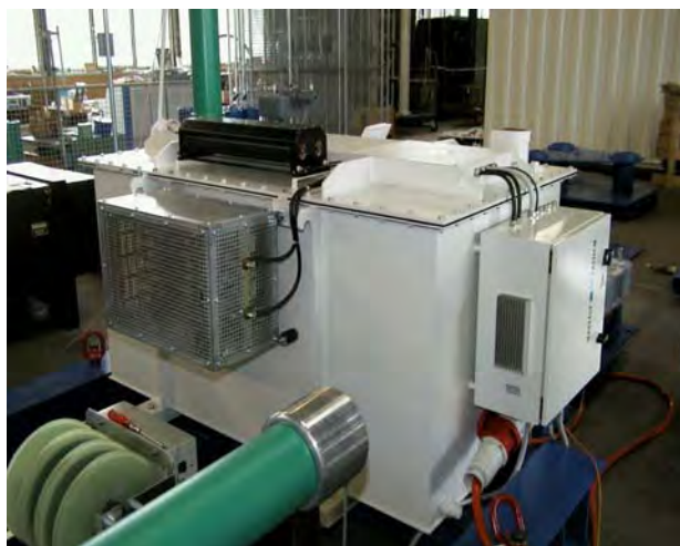
Charging rectifier 200 kV, 60 mA
